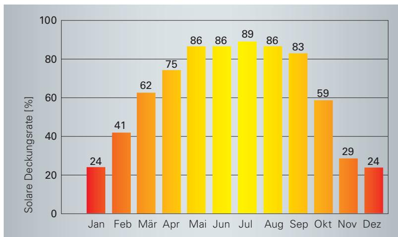
Bei einem Einfamilienwohnhaus deckt Solarenergie bis zu 60 Prozent der für die Trinkwassererwärmung notwendigen Energie ab.
