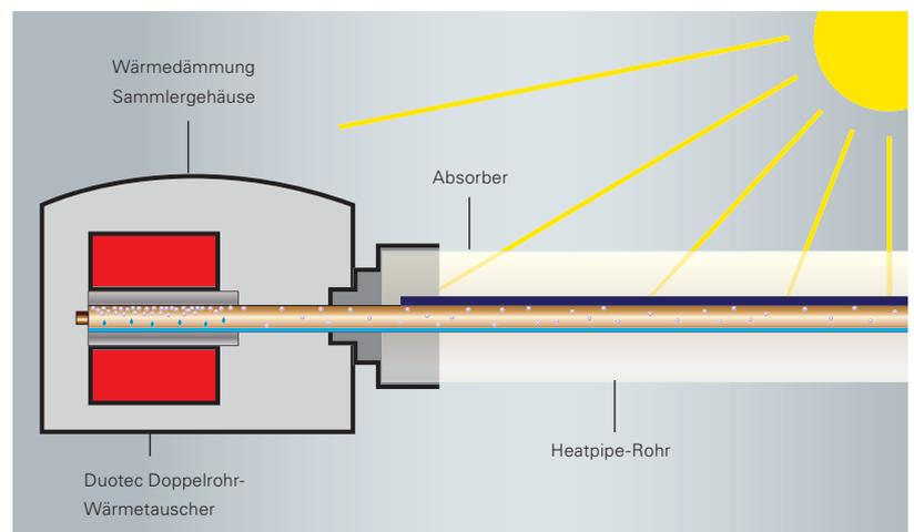
Das von der Sonne erhitzte Wasser verdampft und wandert in den kälteren Teil der Röhre. Dort kondensiert der Dampf, gibt die Wärme an den Sammler ab und wird in einem Kreislauf erneut erhitzt.
